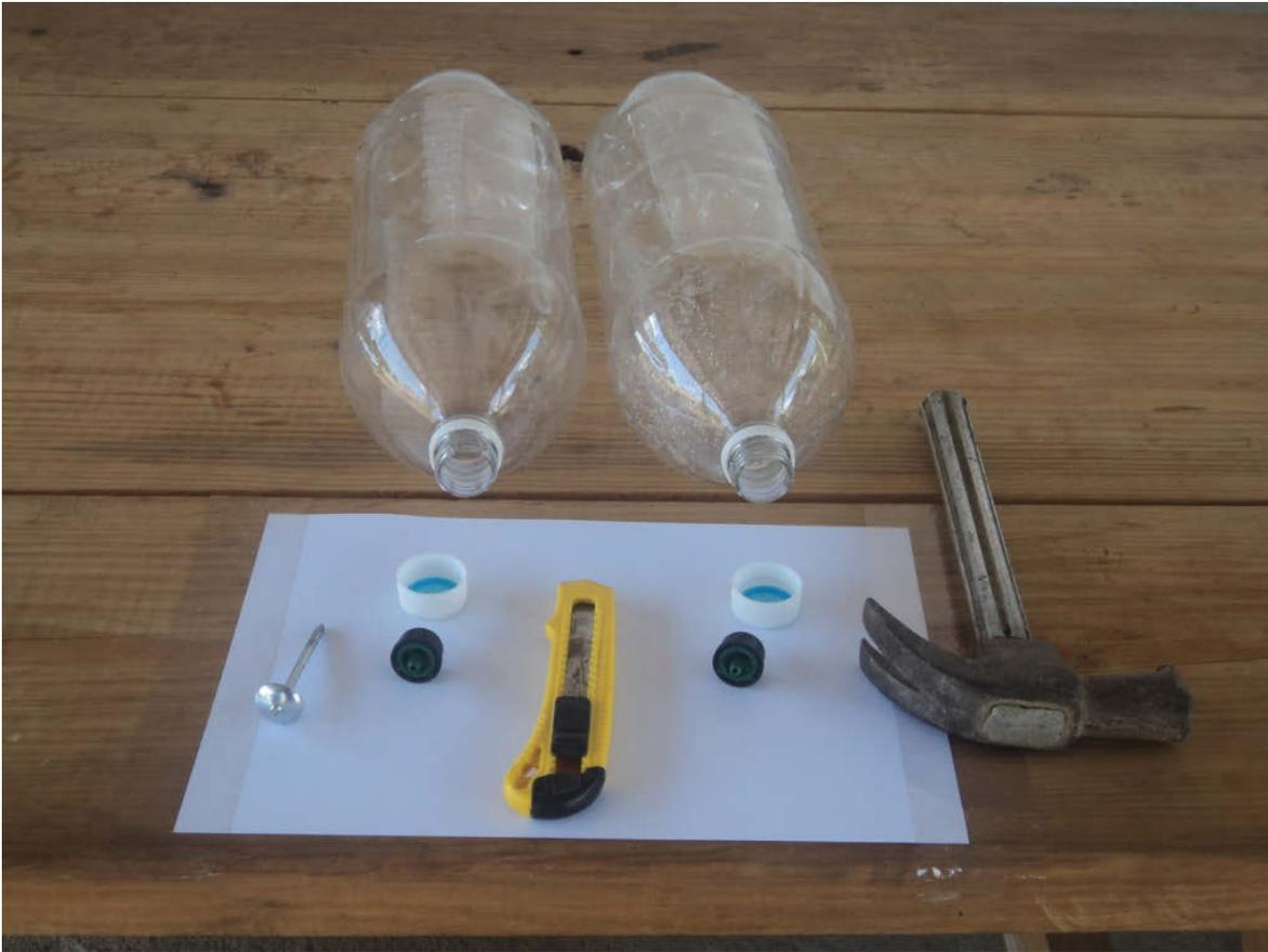
(Foto: Materiales necesarios para adaptar la botella al riego por goteo/Eduardo Murillo)
